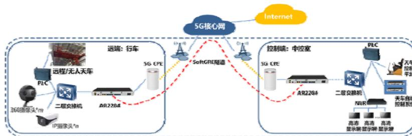
图 2-16 远控天车架构
